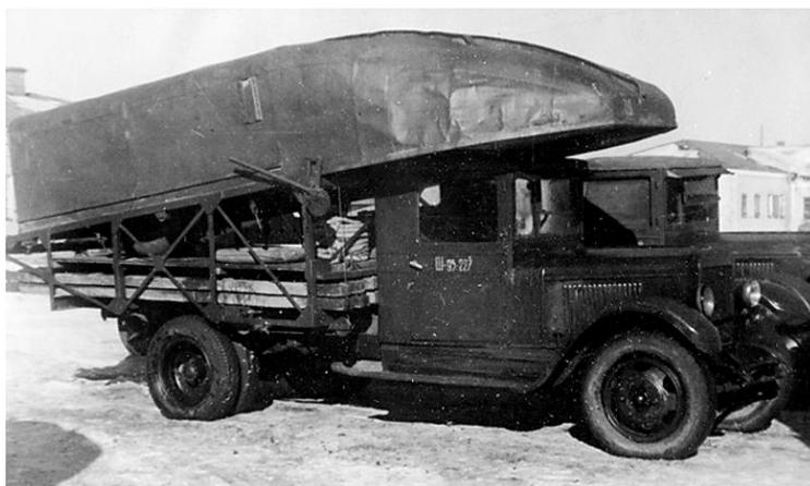
*ЗИС-5А со специальной фермой для перевозки понтонов
